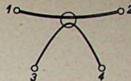
Fig. 2. Het thermocontact, ingesmolten in een glasparel, geïsoleerd van den verwarmingsdraad.
